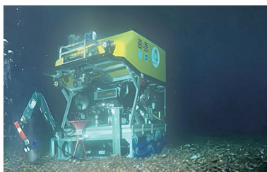
南海水深1522米处,冷泉喷口采集可燃冰。
