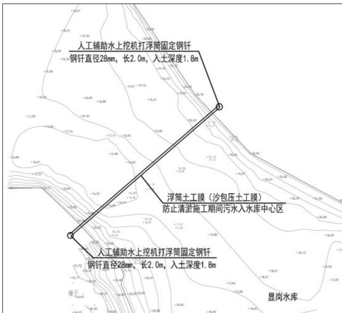
图 4.1-3 隘口浮筒土工膜设计图
