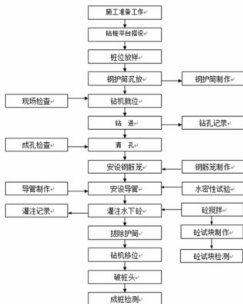
图5 水上钻孔灌注桩施工工艺流程
